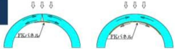
・・・連続炭素繊維シートによる覆工補強工法の特徴を活かして、繊維シート等の補強材を高強度・軽量且つ耐久性に優れた成型パネルを用いて、トンネル・橋梁、その他構造物等を補修・補強する工法である。また、炭素繊維内蔵パネル工法は、覆工コンクリートの剥落防止や塩害進行等を抑えるために表面のからの塩化物イオンの進入を防ぐ目的で繊維パネルをコンクリートパネルと一体化させる工法である。
